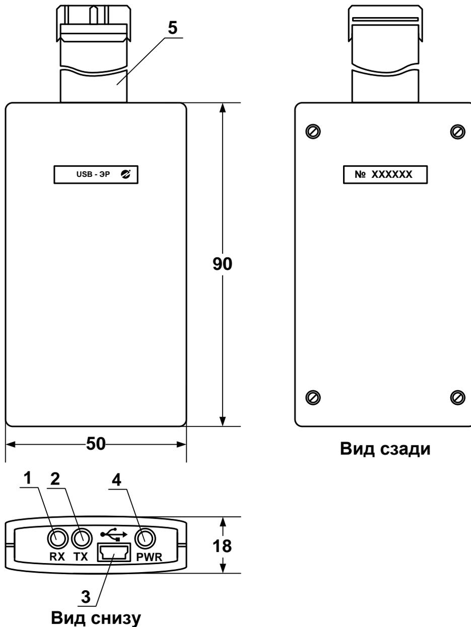
1, 2, 4 – светодиодные сигнализаторы; 3 – разъем mini USB (подключение кабеля интерфейса USB); 5 – шлейф с разъемом IDC-16F (подключение интерфейса UART).
