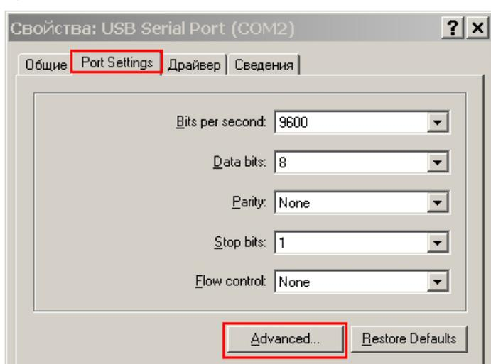
**Рис.3. Вид окна свойств USB Serial Port (COMx) .**
