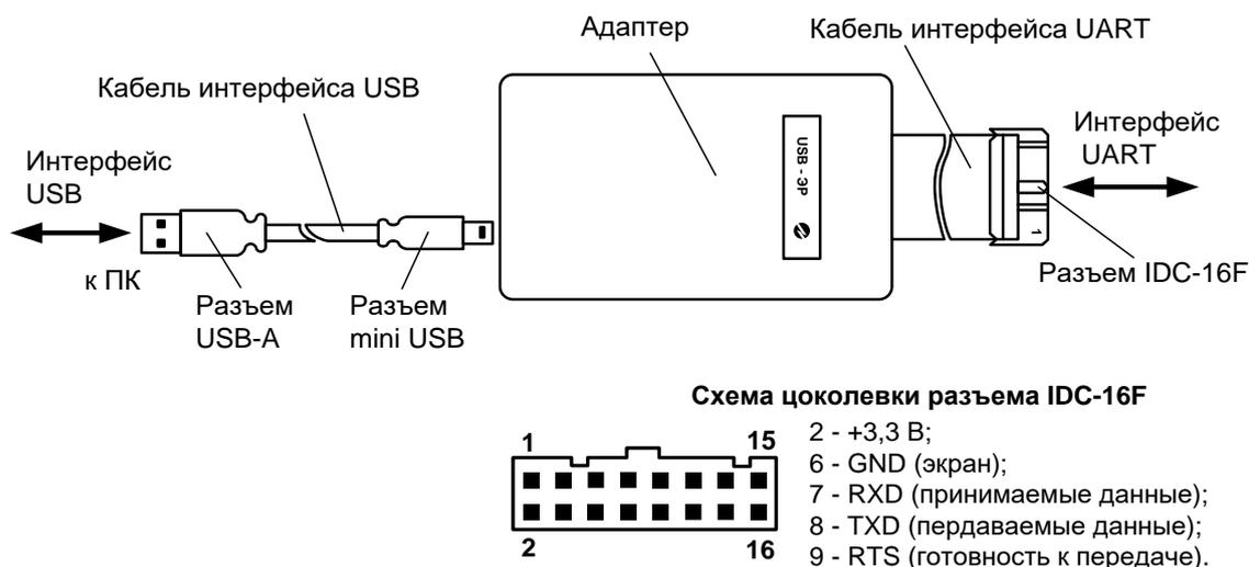
**Рис.1. Схема подключения адаптера.**
